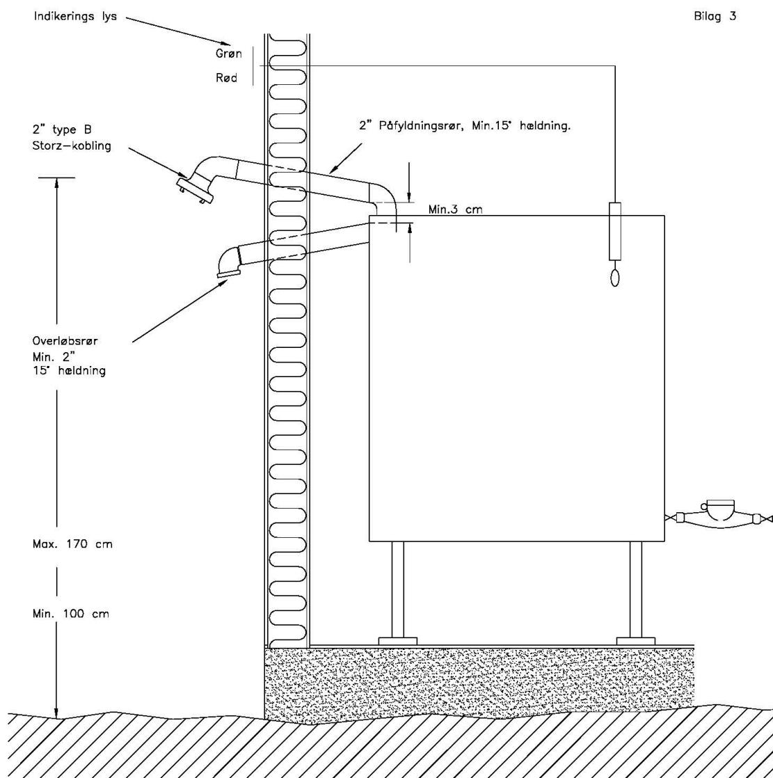
**NB.** For at undgå sprænging af vandtank ved påfyldning med frosset overløbsrør, må overløbsrøret frøstsikres elektrisk (og isoleres) de steder, hvor der er mulighed for stor afkøling.
